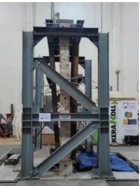
© U. Rome III – Essais de murs en maçonnerie sur table vibrante
