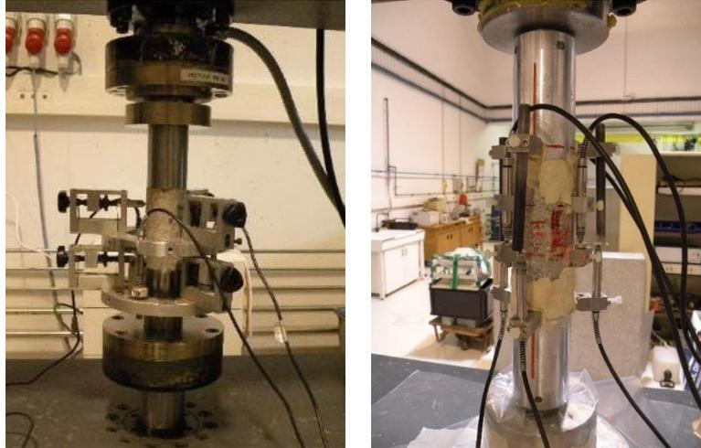
Figure 9 : Essai de compression sur pierre et essai de traction directe sur mortier, issus de (Moreno Regan, 2016)
