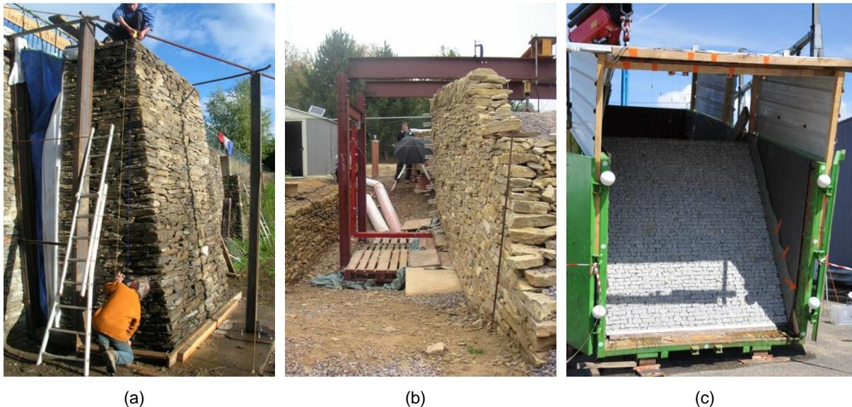
Figure 6 : Essai 2D sur mur en schiste sous chargement hydrostatique (a) selon Villemus (2004), essai 3D sur mur en calcaire soutenant un sol pulvérulent sous charge ponctuelle (b) selon Mundell (2009) et essai 2D à l'échelle 1/10 sur barrage en enrochement avec perré en granite (c) du projet PEDRA
