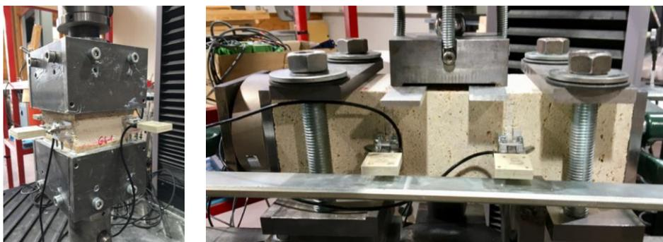
Figure 10 : Essai de traction directe et de cisaillement d'un joint de maçonnerie, issus de (Venzal, 2020)
